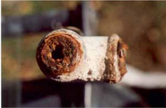
Bei dem Ausbau der alten Wasserleitungen zeigte sich, dass die Rohre zu zwei Drittel zugeroestet waren. Kein Wunder, dass aus den Wasserhähnen rostiges Wasser lief.
